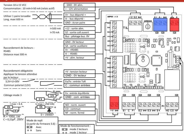
En mode de repli, le relais de commande est alimenté dès que le module est sous tension et le bus correctement raccordé à l'UTL. Assurer la connexion du mécanisme de verrouillage en sécurité positive en câblant l'équipement entre les bornes CO et NO du relais. Les lecteurs raccordées sur ce module doivent être de technologie identique.
